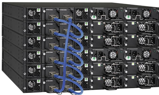
图 1：可以使用标准 SFP+ 和 QSFP+ 端口和光纤将 Ruckus ICX 交换机堆栈在一起，以便搭建最远距离达 10 km 的单台逻辑设备。
